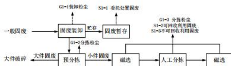
图 4-1 一般工业固废分拣线工艺流程及产污环节
