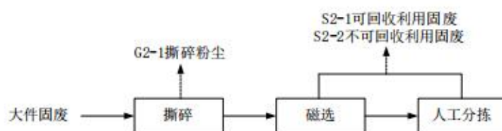
图 4-2 大件垃圾破碎线
