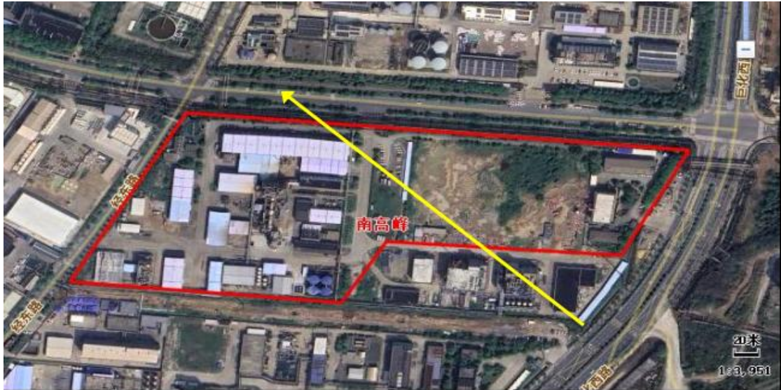
图3.1-2 地下水位流向图
