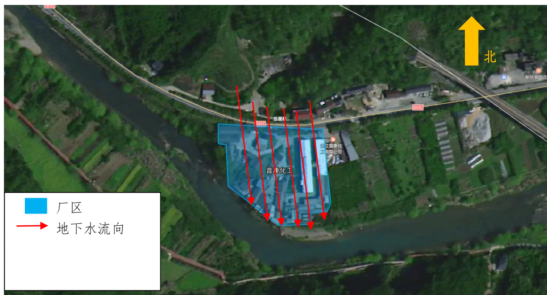
图 3-1 地下水位流向图
