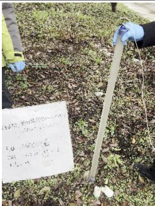
贝勒管中无水样，无法采集地下水
