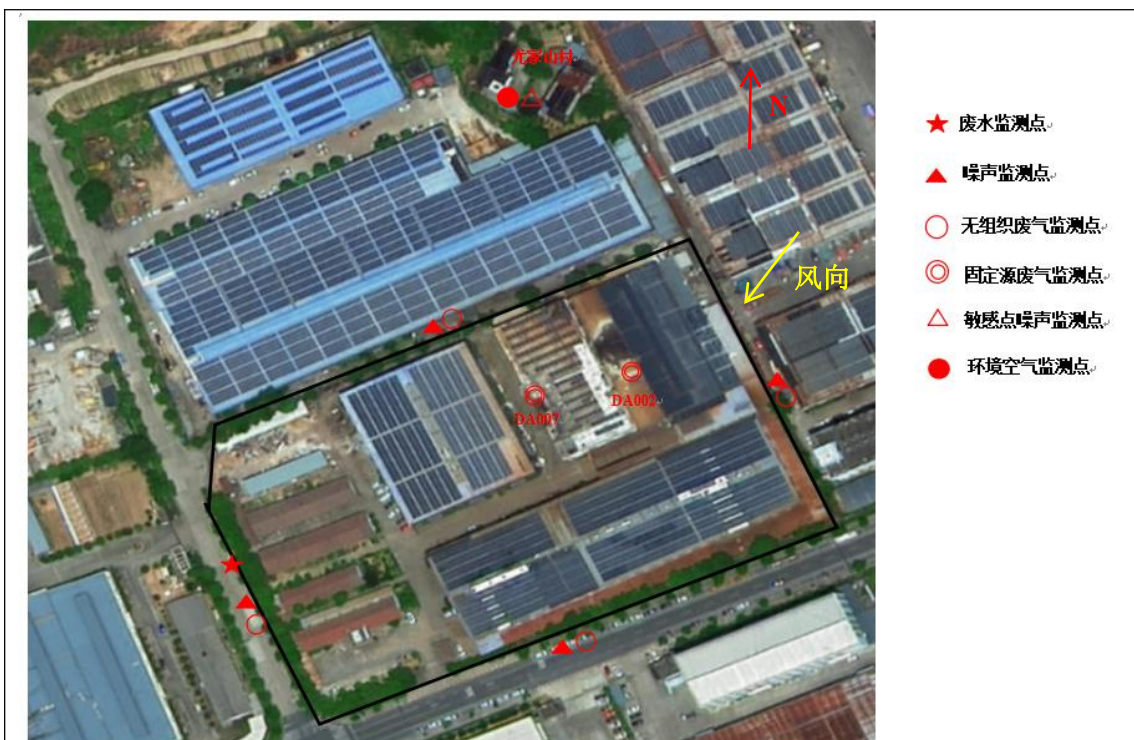
图 7-3 项目监测点位布置示意图
