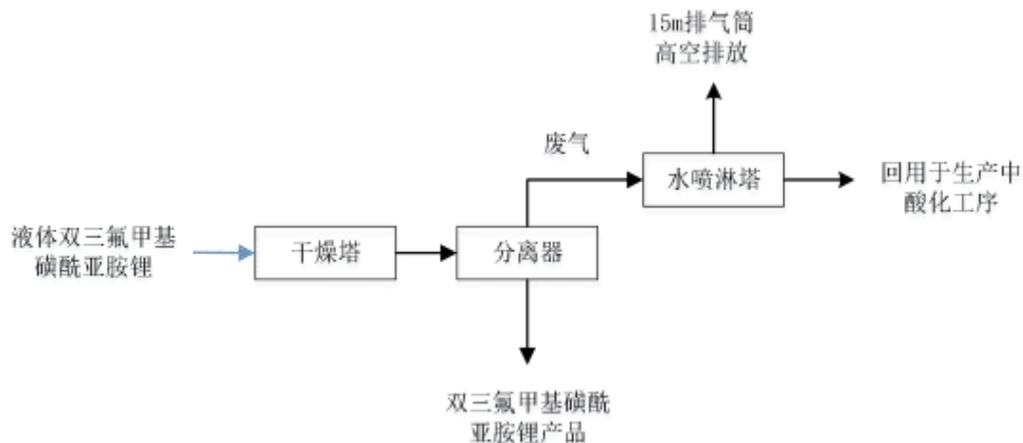
图 4.1-7 双三氟甲基磺酰亚胺锂盐干燥包装工艺流程及产污环节图
