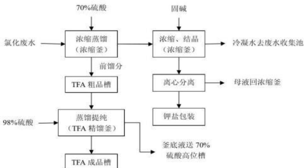
图 4.1-3 氯化废水回收处理工艺流程
