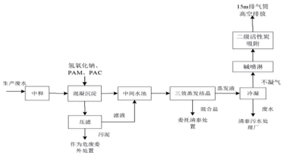
图 4.1-10 污水处理站工艺流程图
