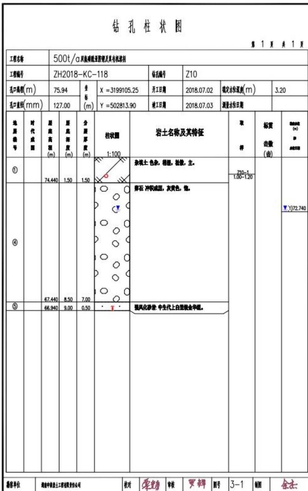
图 3.1-2 钻孔柱状图
