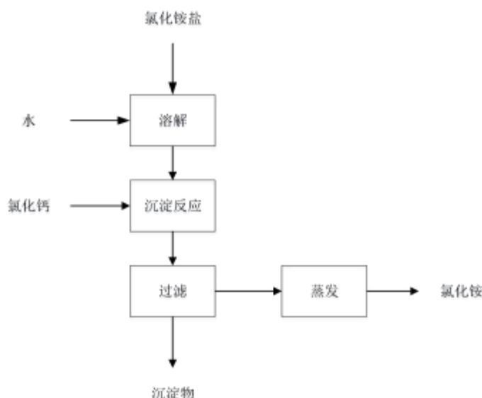
图 4.1-6 氯化铵回收工艺流程图
