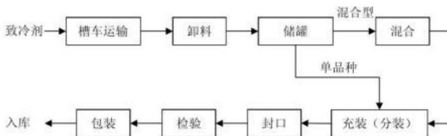
图 4.1-4 致冷剂分装工艺流程图
