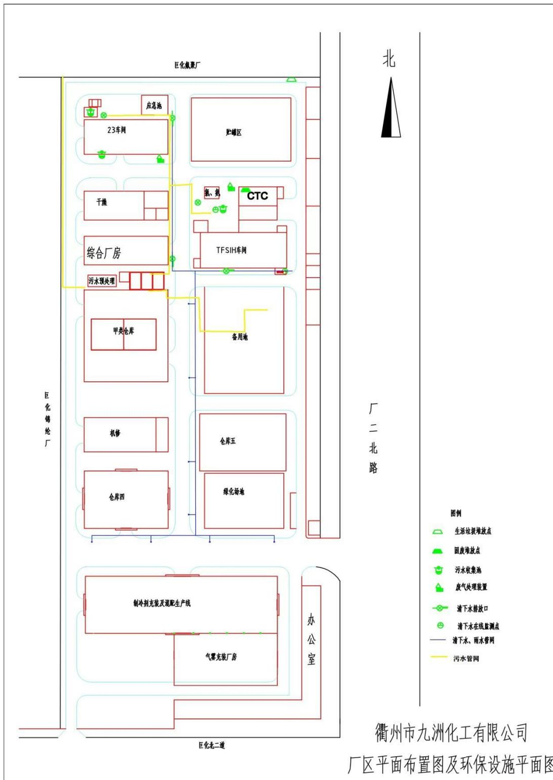
图 4.2-3 厂区雨污水管网图
