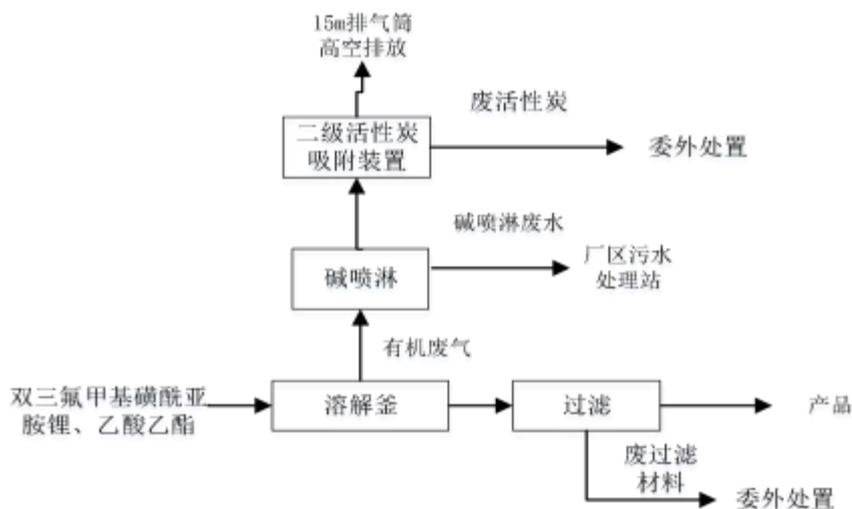
图 4.1-8 双三氟甲基磺酰亚胺锂盐有机溶液生产工艺流程及产污环节图
