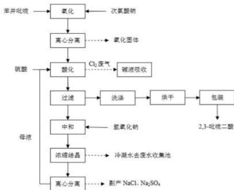
图 4.1-1 2,3-吡啶二酸生产工艺流程图
