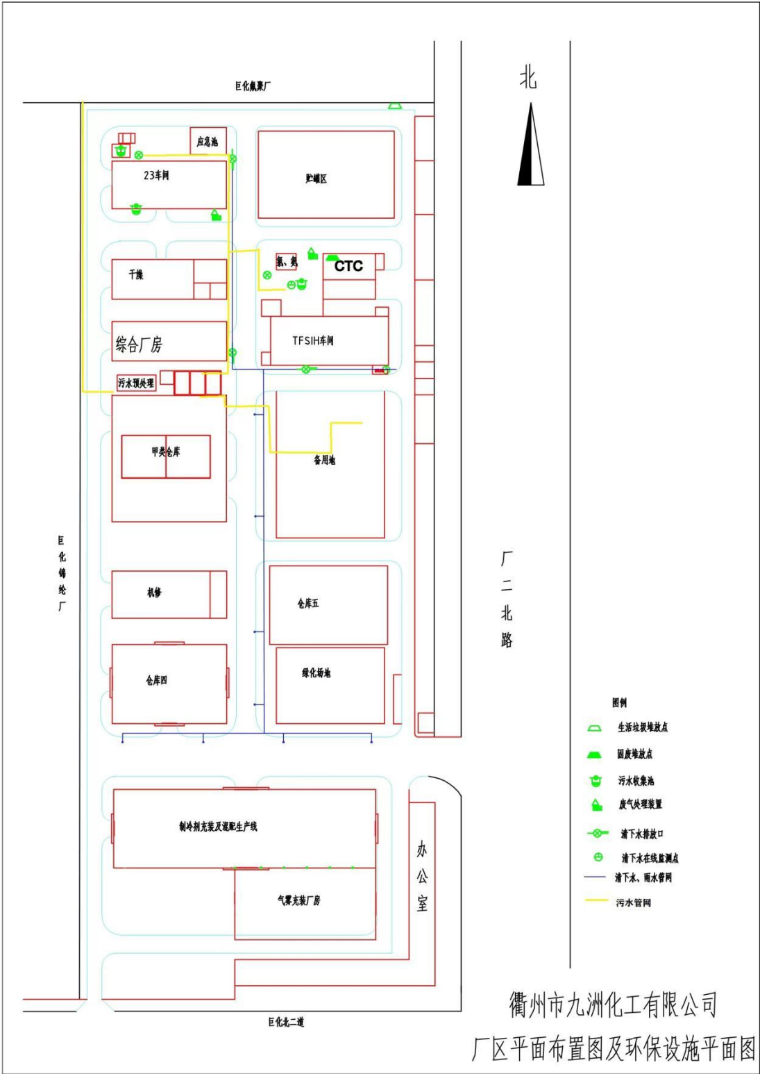
图 4.2-3 厂区雨污水管网图
