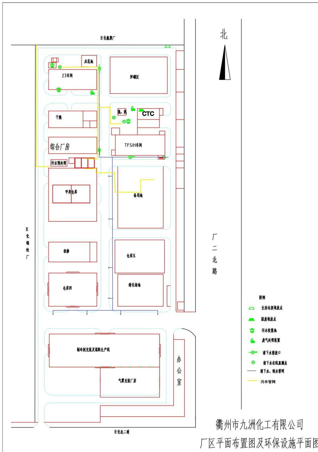
图 4.2-3 厂区雨污水管网图
