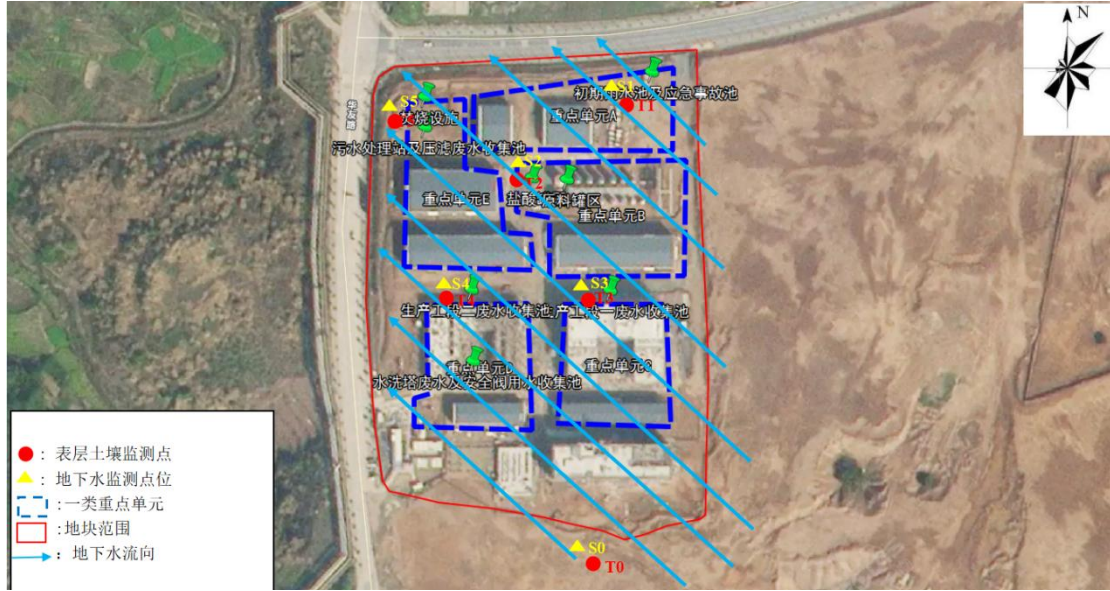
图 2.3-1 土壤环境自行监测点位布设位置示意图
