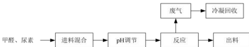
图 4.1-2 脲醛树脂胶生产工艺流程图
